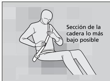
3. Coloque la sección de la cadera del cinturón de seguridad lo más bajo posible sobre las caderas, y luego tire hacia arriba de la sección del hombro para que la sección de la cadera quede bien ajustada. De este modo los robustos huesos pélvicos recibirán la fuerza de un impacto, con lo que se reduce el riesgo de que se produzcan lesiones internas.
