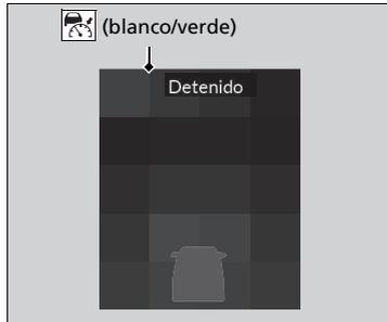
Si no tiene ningún vehículo delante antes de reanudar la conducción, pise el pedal del acelerador y el ACC con seguimiento de baja velocidad volverá a funcionar con la anterior velocidad programada.
