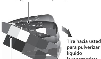
Tire hacia usted para pulverizar líquido lavaparabrisas.
