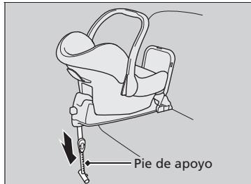
5. Asegúrese de que el sistema de sujeción infantil esté firmemente sujeto; para ello, balancéelo hacia delante y atrás, hacia los lados; debe percibirse un movimiento mínimo.
