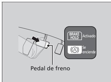
Pise el pedal del freno para detener el vehículo completamente. La transmisión no debe estar en la posición **P** ni **R**.
