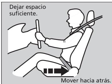
Ajuste el asiento del conductor lo más atrás posible, en una posición que le permita mantener el control total del vehículo. Deberá poder sentarse con la espalda recta bien apoyada en el respaldo y pisar adecuadamente los pedales, sin tener que inclinarse hacia adelante, y sujetar el volante con comodidad. El asiento del acompañante deberá ajustarse de forma similar, para que permanezca lo más alejado posible del airbag frontal del salpicadero.
