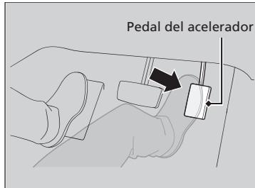
Pise suavemente el pedal del acelerador. Si está en un pendiente, puede ser necesario pisar más el acelerador para liberarlo.
