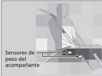
El sistema de airbag frontal avanzado del acompañante dispone de sensores de peso. Los sensores se usan para la clasificación del ocupante, para activar o desactivar el airbag del acompañante.
