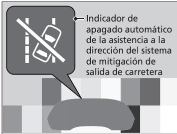
A continuación, el indicador de apagado automático de asistencia de conducción del sistema de mitigación de salida de carretera se enciende, la asistencia de conducción de mitigación de salida de carretera se detiene temporalmente, y el sistema solo le alerta con el sonido de advertencia.
