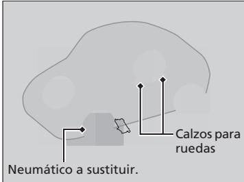
**4.** Coloque un calzo para ruedas o una roca delante y detrás de la rueda opuesta en diagonal al neumático pinchado.
