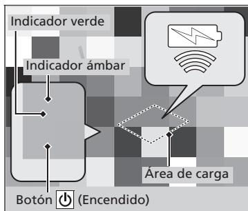
1. Para encender y apagar el sistema, mantenga pulsado el botón
