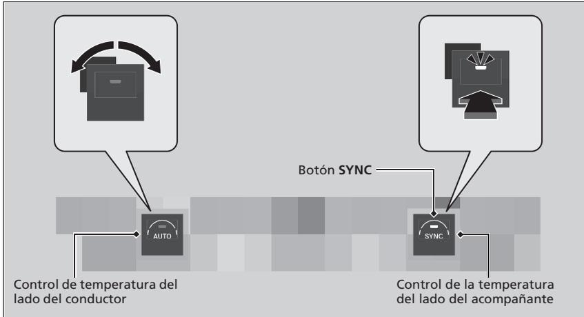
Es posible ajustar la temperatura a la vez para el lado del conductor y del acompañante en modo sincronizado.
