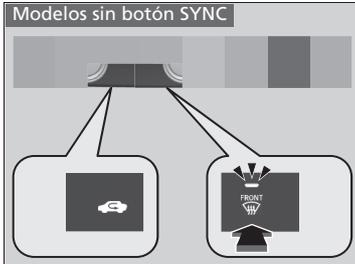
Al pulsar el botón
