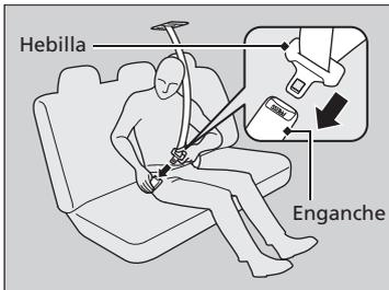
3. Introduzca la hebillita en el enganche. Ajuste adecuadamente el cinturón de seguridad de la misma forma que ajusta el cinturón de seguridad de tres puntos.
