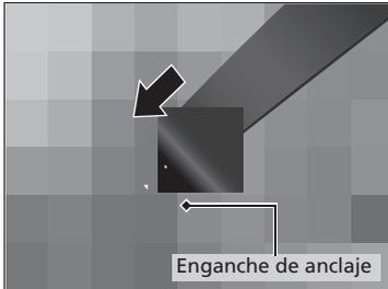
2. Alinee las marcas triangulares de la hebillita pequeña y del enganche de anclaje. Asegúrese de que el cinturón de seguridad no esté retorcido. Fije el cinturón al enganche de anclaje.
