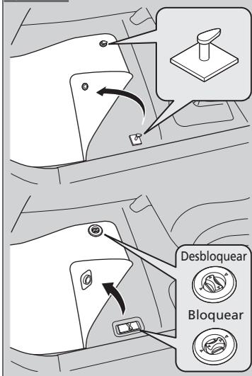
La alfombra del suelo del conductor queda enganchada por encima de los anclajes del suelo, lo que impide que se deslice hacia delante.
