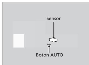
Al conducir de noche, el retrovisor de oscurecimiento automático reduce el resplandor de los faros del vehículo que circula detrás. Pulse el botón AUTO para activar y desactivar esta función. Al activarla, se enciende el testigo AUTO.
