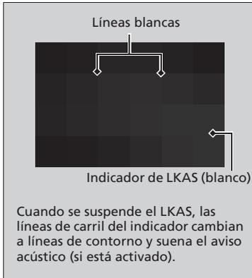
■ **El funcionamiento del sistema se suspende si:**
