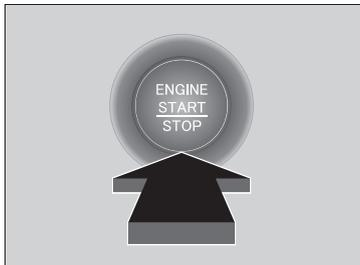
Si lleva encima el control a distancia de acceso sin llave y pulsa el botón **ENGINE START/STOP** sin pisar el pedal de freno, el modo de alimentación cambiará en este orden: VEHÍCULO APAGADO→ACCESORIOS→CONTACTO→VEHÍCULO APAGADO.
