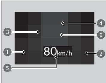
Puede ver el estado actual del control de crucero adaptativo (ACC) con seguimiento de baja velocidad, el sistema de asistencia de permanencia en carril (LKAS) y la asistencia en atascos\*.
