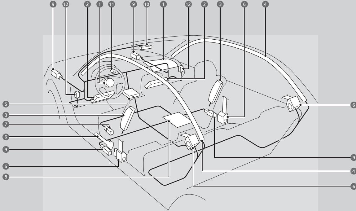
Los airbags frontales, de rodilla del conductor, de rodilla del acompañante, laterales y de cortina se despliegan en función de la dirección y la fuerza del impacto. El sistema de airbag consta de:
