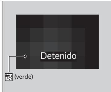
Si no tiene ningún vehículo delante antes de reanudar la conducción, pise el pedal del acelerador y el ACC con seguimiento a baja velocidad volverá a funcionar con la anterior velocidad programada.
