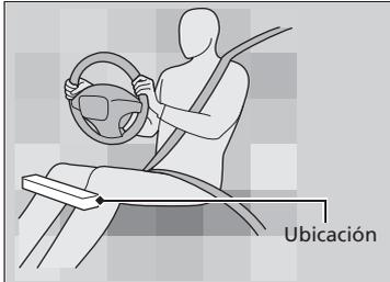
El airbag de rodilla del conductor y el del acompañante están almacenados debajo de la columna de la dirección y de la guantera, respectivamente.
