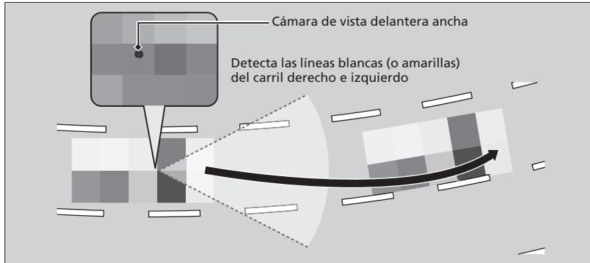
Si señala un cambio de carril con el intermitente, el sistema de asistencia en atascos se desactiva temporalmente. Se vuelve a activar cuando el vehículo circula por el centro del carril y el sistema ha detectado las líneas de carril.
