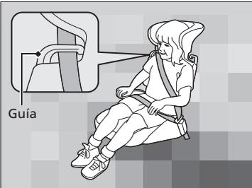
Hay disponible un respaldo para un asiento elevador determinado. Instale el respaldo en el cojín elevador y ajústelo al asiento del vehículo siguiendo las instrucciones del fabricante del cojín elevador. Asegúrese de que el cinturón de seguridad se pasa correctamente a través de la guía del hombro del respaldo y que el cinturón no toca ni cruza el cuello del niño.
