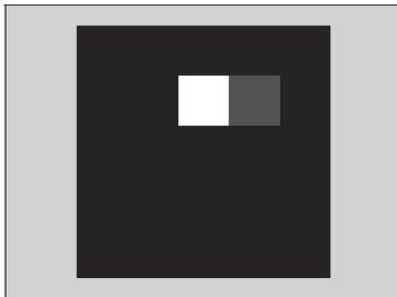
Si se encienden dos barras, aparece el mensaje **Nivel de atención de conductor bajo.**
