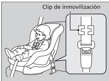
6. Asegúrese de que el sistema de sujeción infantil esté firmemente sujeto; para ello, balancéelo hacia delante y atrás, hacia los lados; debe percibirse un movimiento mínimo.
