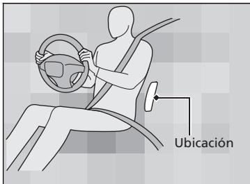
Los airbags laterales se alojan en el borde exterior de los respaldos de los asientos del conductor y del acompañante.
