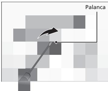
2. Para abrir la compuerta trasera, empújela mientras desliza la palanca hacia la derecha con un desarmador de punta plana.
