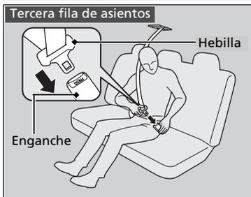
3. Introduzca la hebilla en el enganche. Ajuste adecuadamente el cinturón de seguridad de la misma forma que ajusta el cinturón de seguridad de tres puntos.
